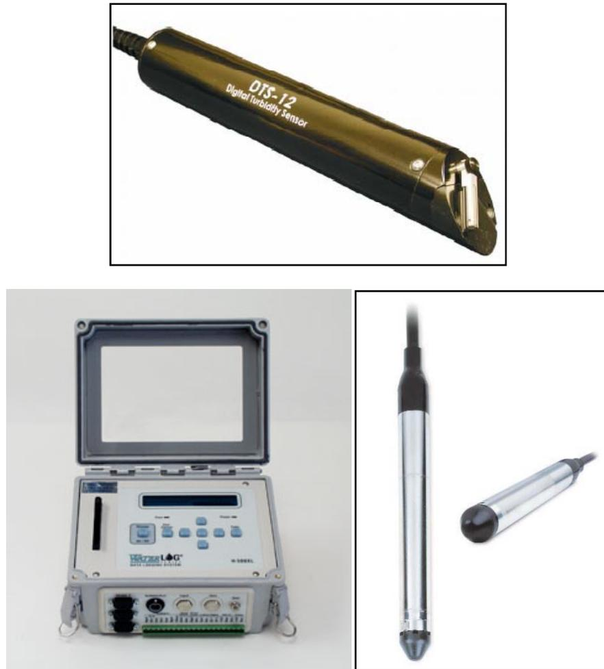
Figura 2: Detalhe dos equipamentos instalados na estação hidrosedimentológica.
